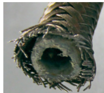
ADDINOL Cliptec XHS 280 Место подвода смазочного материала без отложений, полная пропускная способность
