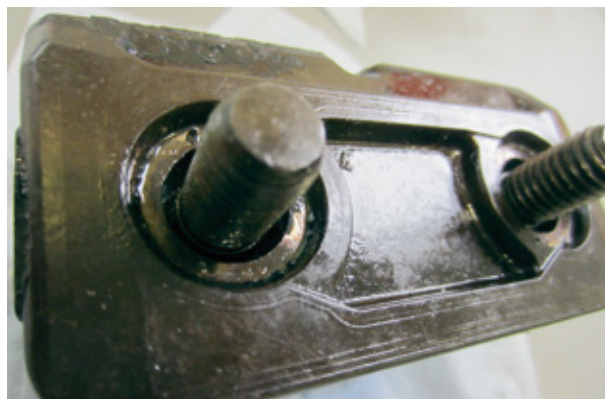
Деталь цепи без отложений приблизительно после 18 500 рабочих часов с применением ADDINOL Cliptec XHS 280
