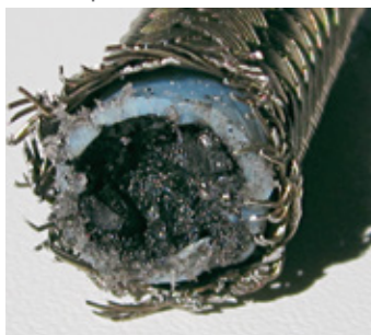
Конкурирующий продукт Место подвода смазочного материала заблокировано отложениями
