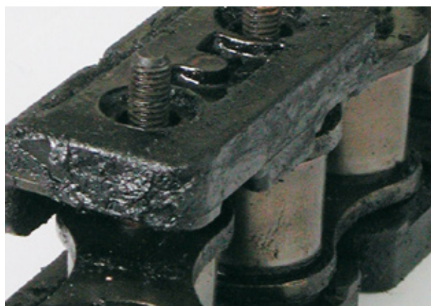
Деталь цепи с черным налетом после 21 000 рабочих часов с применением конкурирующего продукта
